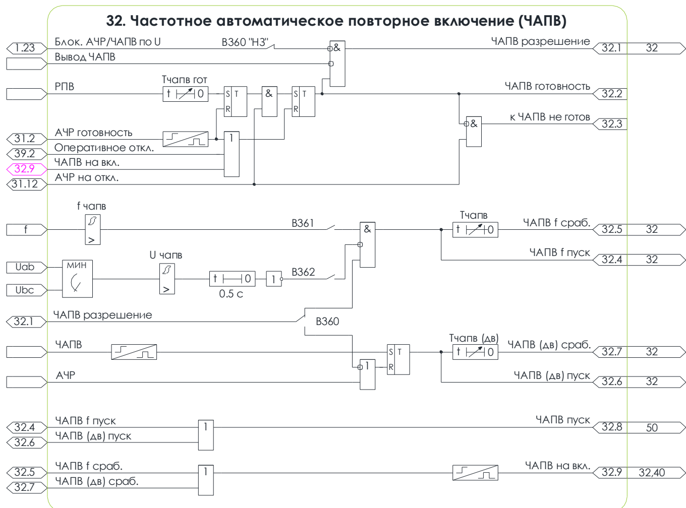
Рисунок 9.2 – Схема №32. Алгоритм ЧАПВ
