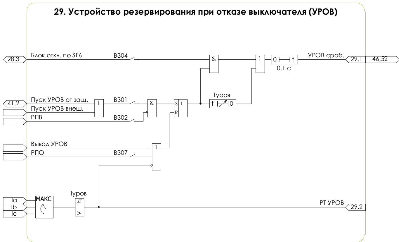
Рисунок 8.2 – Схема №29. Алгоритм УРОВ
