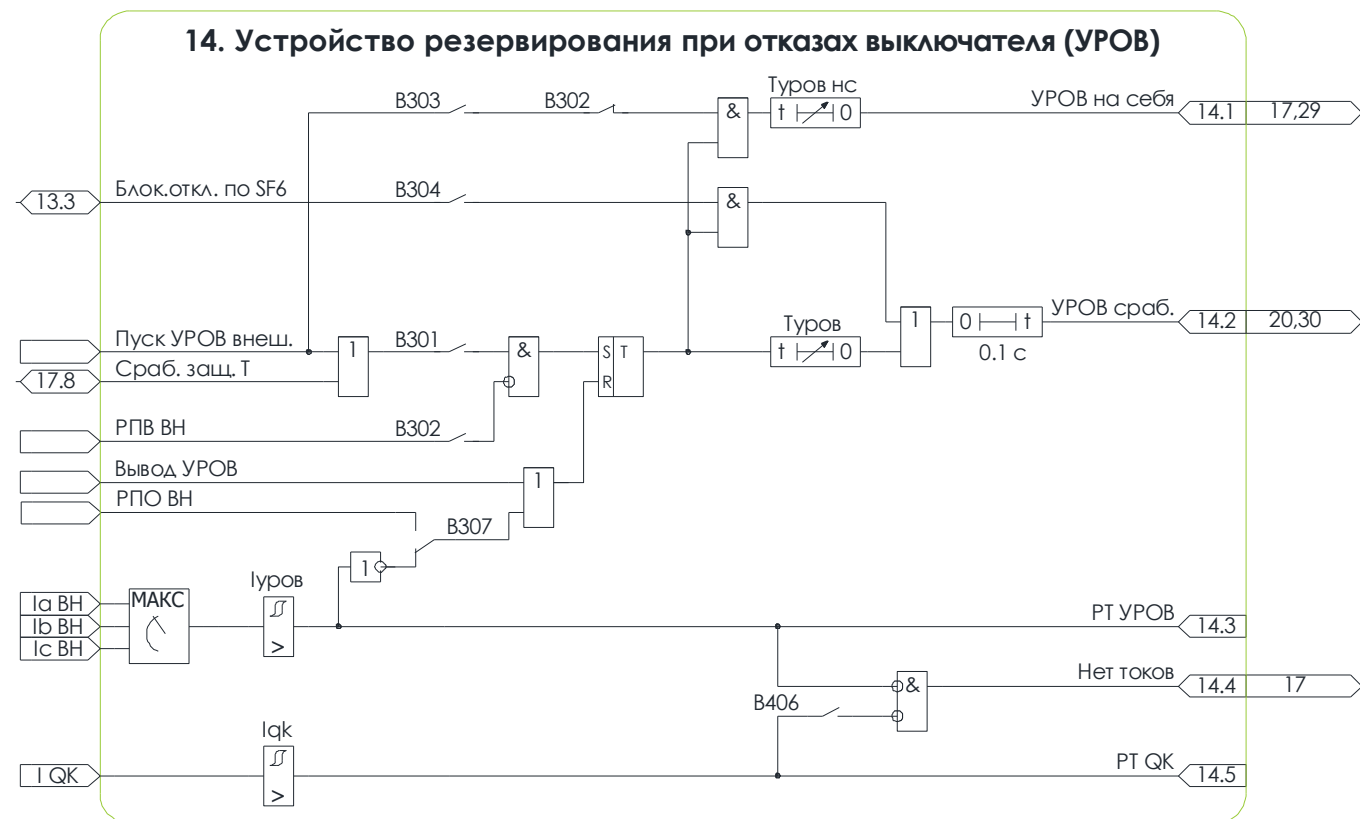
Рисунок 3.21 – Схема №14. Алгоритм УРОВ
