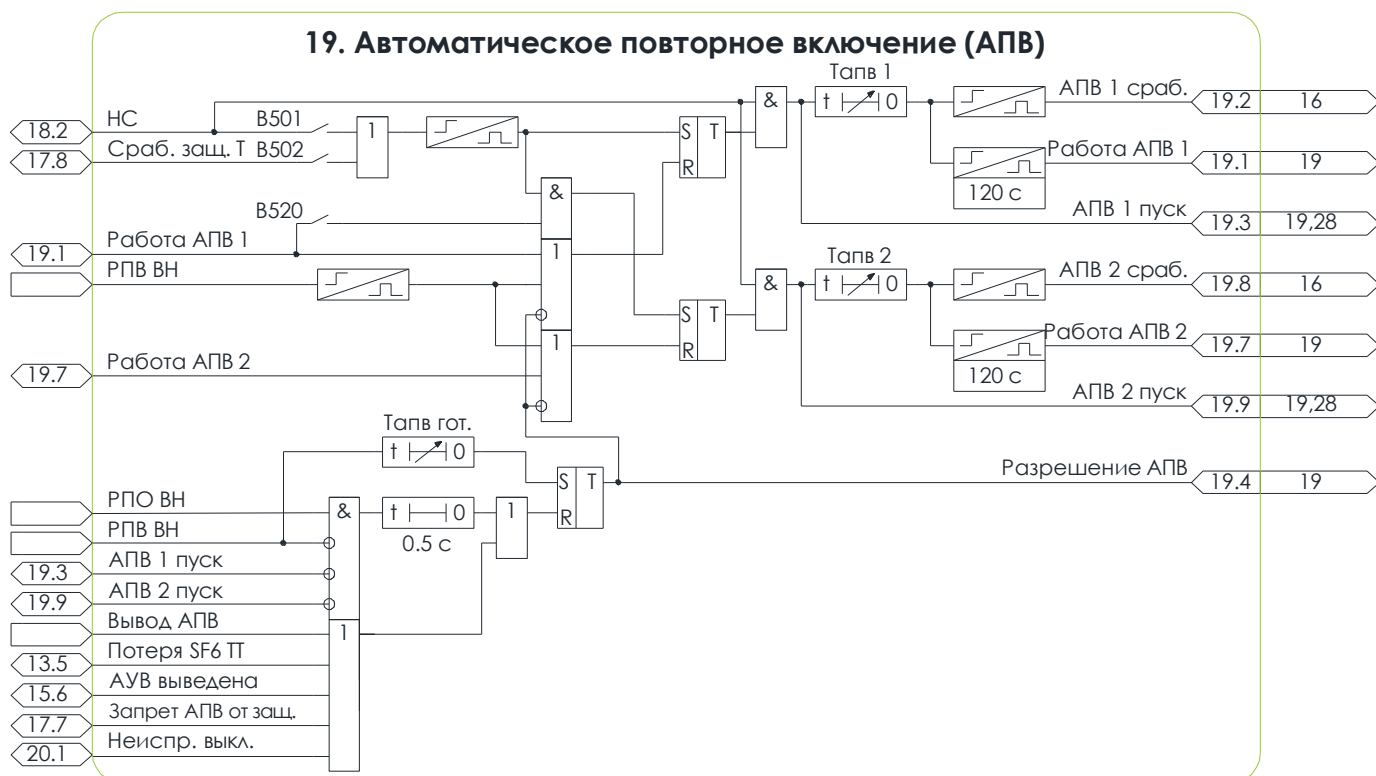
Рисунок 4.5 – Схема №19. Алгоритм АПВ
