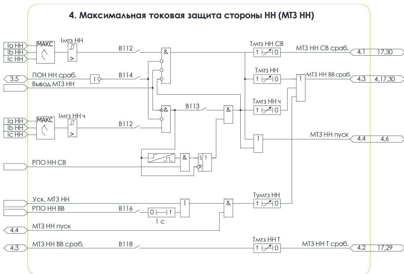
Рисунок 3.8 – Схема №4. Алгоритм МТЗ НН
