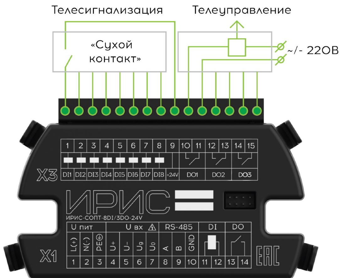
Рисунок 10.5 - Схема подключения рюкзака ИРИС-СОПТ- 8DI/3DO-24V
