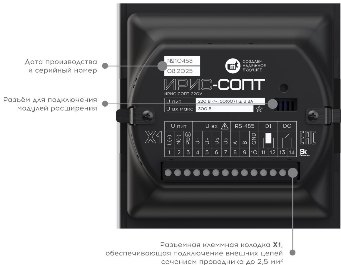
Рисунок 2.3 - Внешний вид задней панели ИРИС-СОПТ
