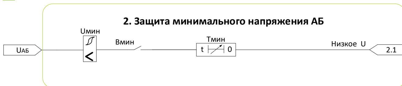
Рисунок 4.2– Алгоритм защиты минимального напряжения АБ
