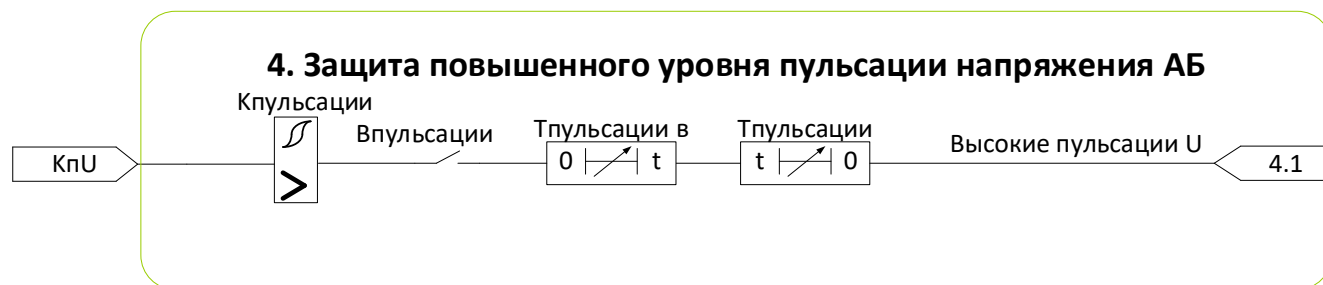
Рисунок 4.4– Алгоритм защиты повышенного уровня пульсации напряжения АБ
