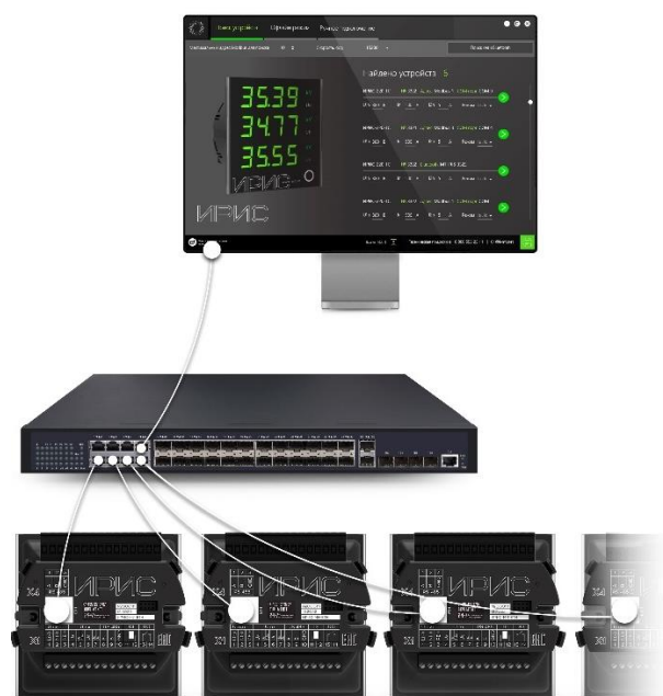
Рисунок 10.4– Схема организации сети Ethernet
