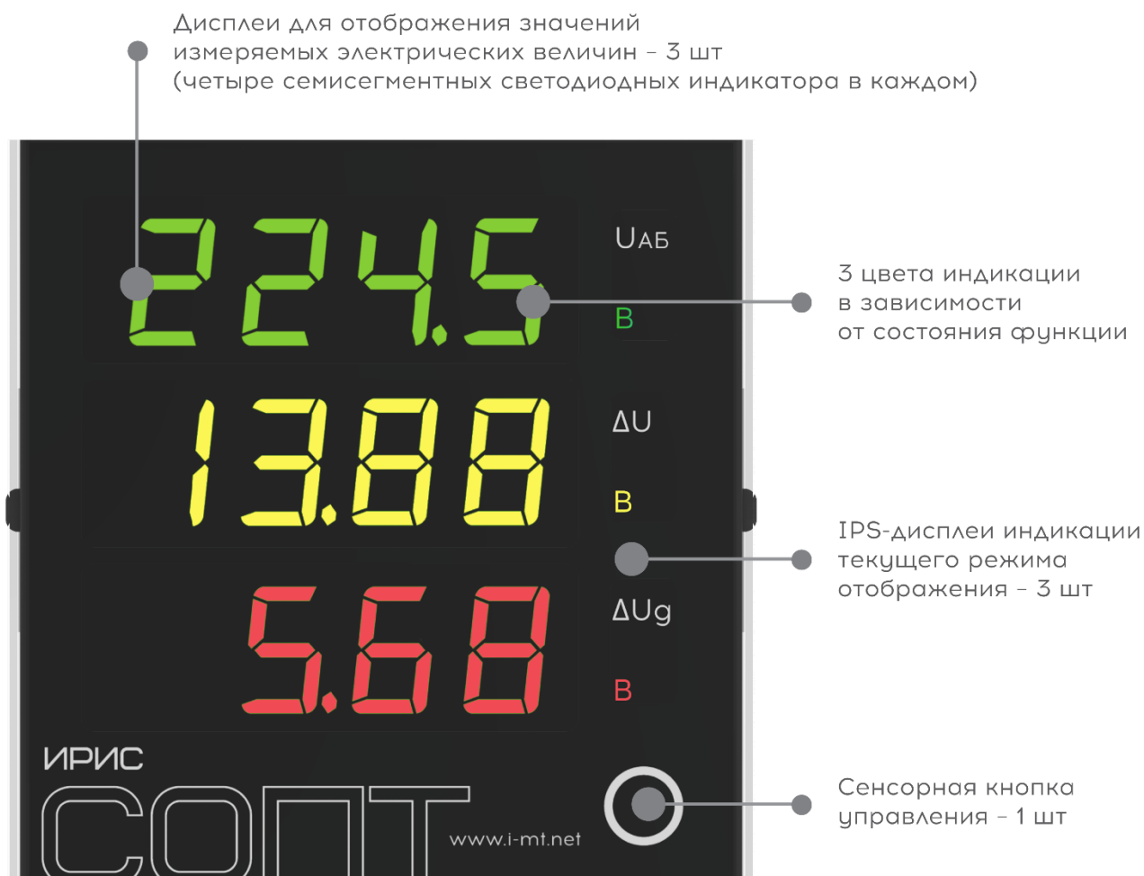
Рисунок 2.2 - Внешний вид лицевой панели ИРИС-СОПТ
