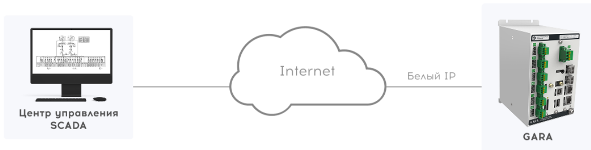
Рисунок 4.22 – Схема организации связи с GARA при использовании белого IP
