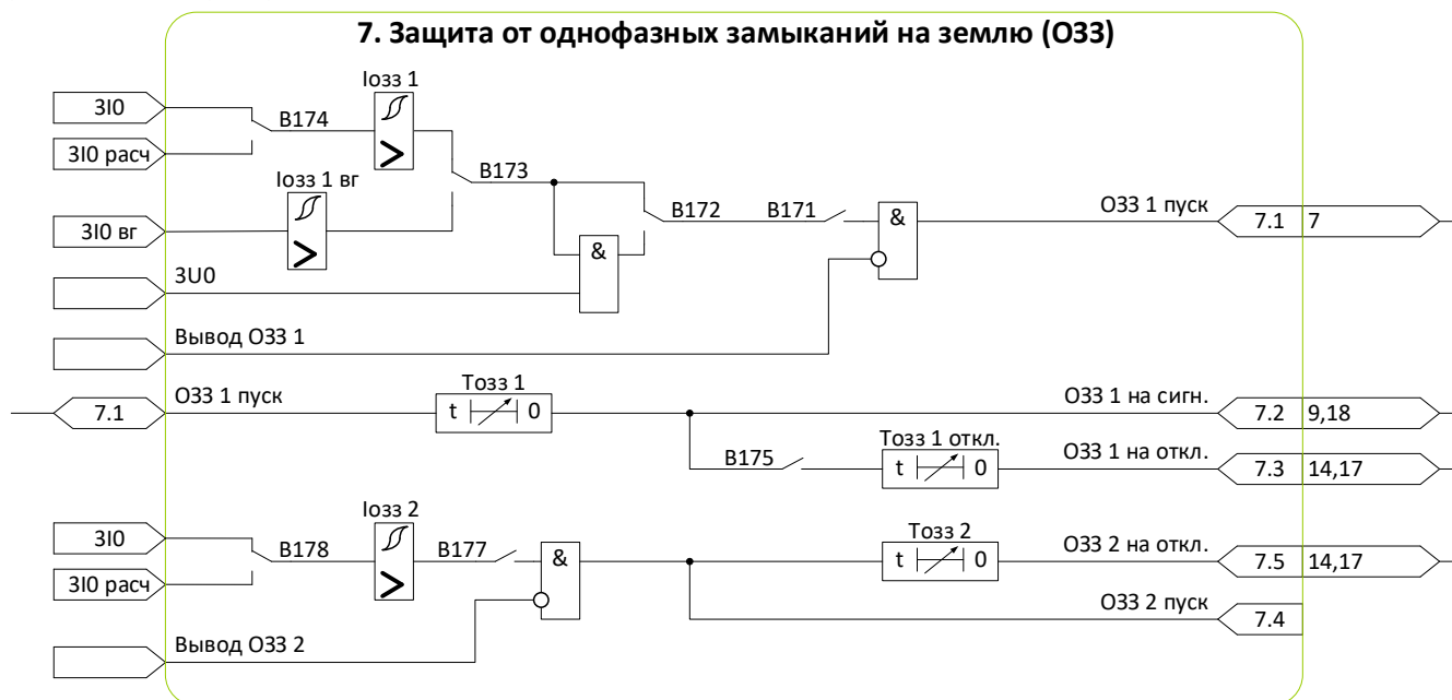
Рисунок 7.10 – Схема №7. Алгоритм ОЗЗ
