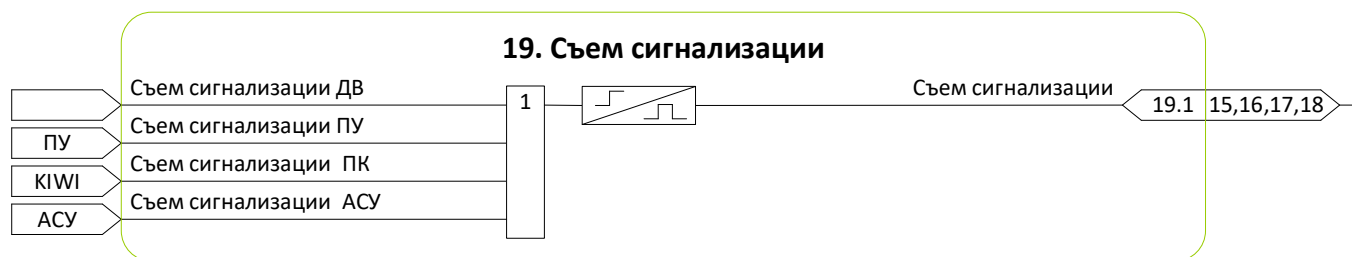
Рисунок 7.24 – Схема №19. Алгоритм съема сигнализации
